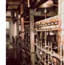
Risalente alla fine del XVII secolo, la sua particolarità consiste nei torcitoi a bacchetta del tipo "bergamasco" messi in funzione da tre ruote del diametro di sette metri, alimentate dal torrente "Rio di Ello". Il filatoio è di proprietà privata.
